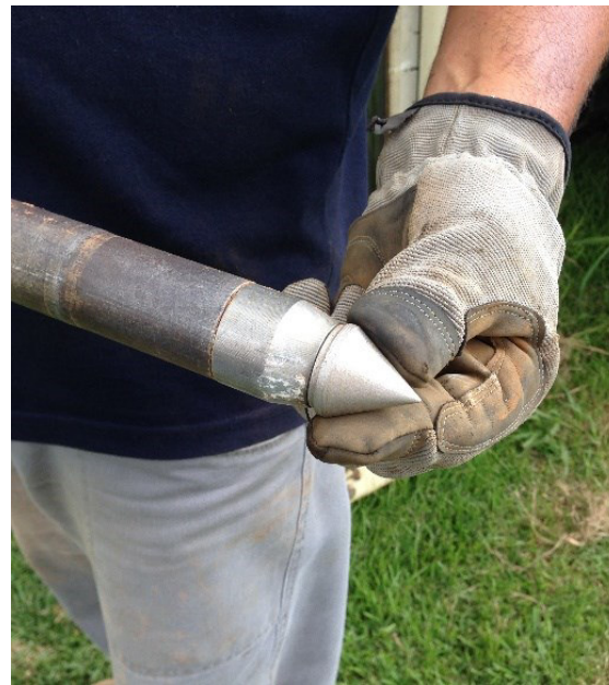
Amostragem de gases do solo com sistema Post Run Tubing (PRT)
