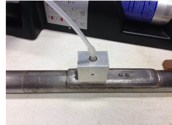
Sistema MIP montado sobre a bancada e dispositivo de injeção de gases
