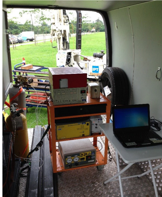
Sistema MIP em operação
