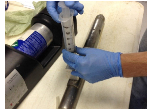
Preparação e injeção das misturas gasosas na sonda MIP.
